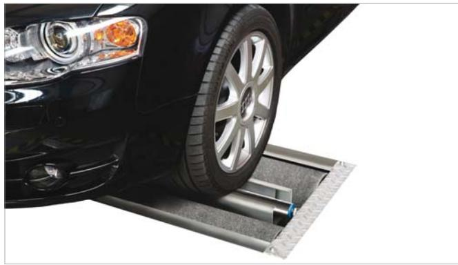
При поднятой балке автомобиль может легко въезжать на стенд и съезжать с него. Автомобили со спортивной подвеской, с малым клиренсом, с колёсами малого радиуса легко устанавливаются на стенд без опасности повреждения днища. Внимание. Необходимо предусмотреть соответствующий фундамент, подвод воздуха 8 бар. Грузоподъёмность балки 3 т.
