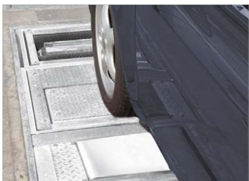
Износ амортизаторов – постепенный процесс, обычно не замечаемый водителем. Тестер подвески менее чем за минуту позволяет определить причину опасного поведения автомобиля при прохождении кривой, неравномерного износа шин, вибрации руля, нестабильного движения при боковом ветре, неэффективного торможения.
